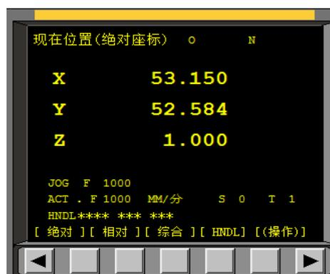
(b) 基准刀 Z 向 G54 坐标系 POS 显示
