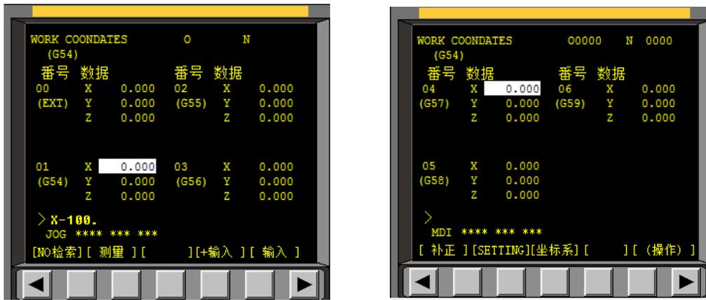
(a) No1~No3 (G54~G56) 坐标系设置画面 (b) No1~No3 (G57~G59) 坐标系设置画面
