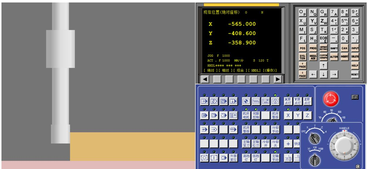
图 1.22 寻边器 X 方向对刀
