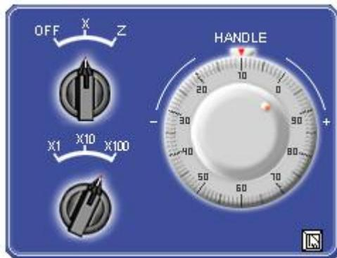
图 1.44 手动脉冲（手轮）发生器
