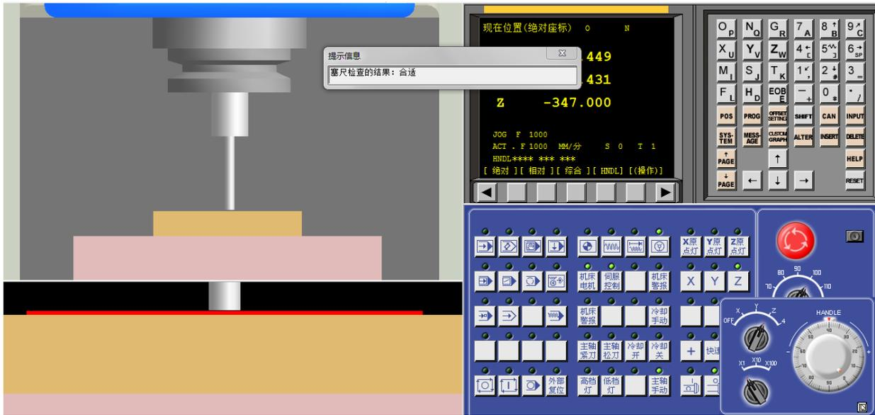
图 1.26 铣床的 Z 向塞尺对刀
