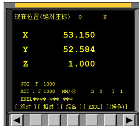
图 1.30 当前刀具在 G54 坐标系下的坐标值
