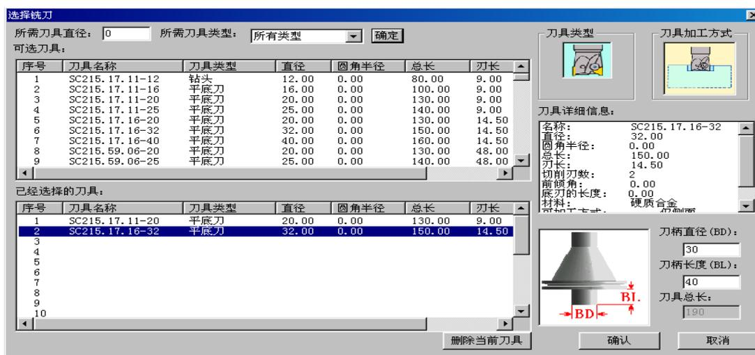
图 1.13 铣床和加工中心指定刀位号
