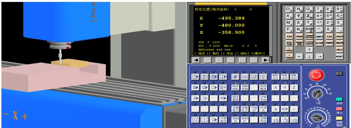
图 1.24 寻边器 Y 方向对刀
