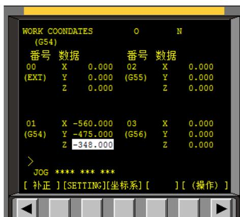
图 1.29 G54 工件坐标系设定
